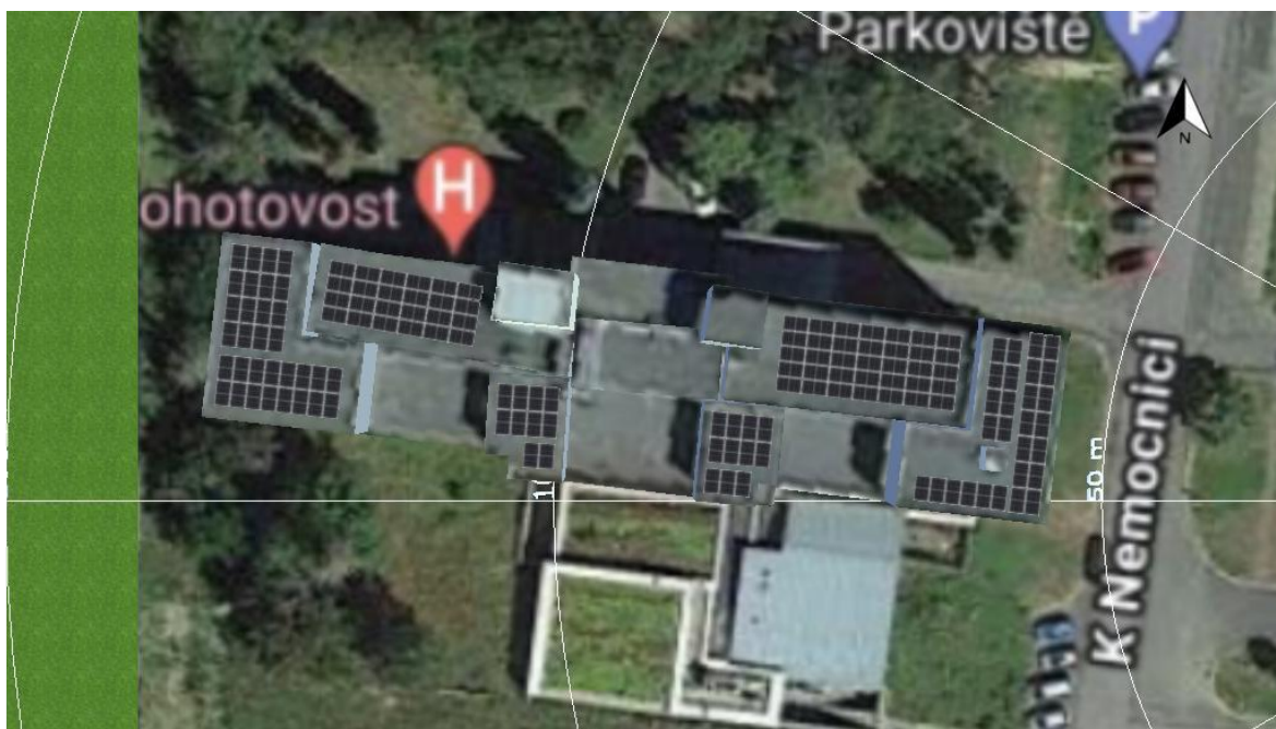
Obr. 39: Předpokládané rozmístění FVE panelů na střechě objektu Pavilonu C
