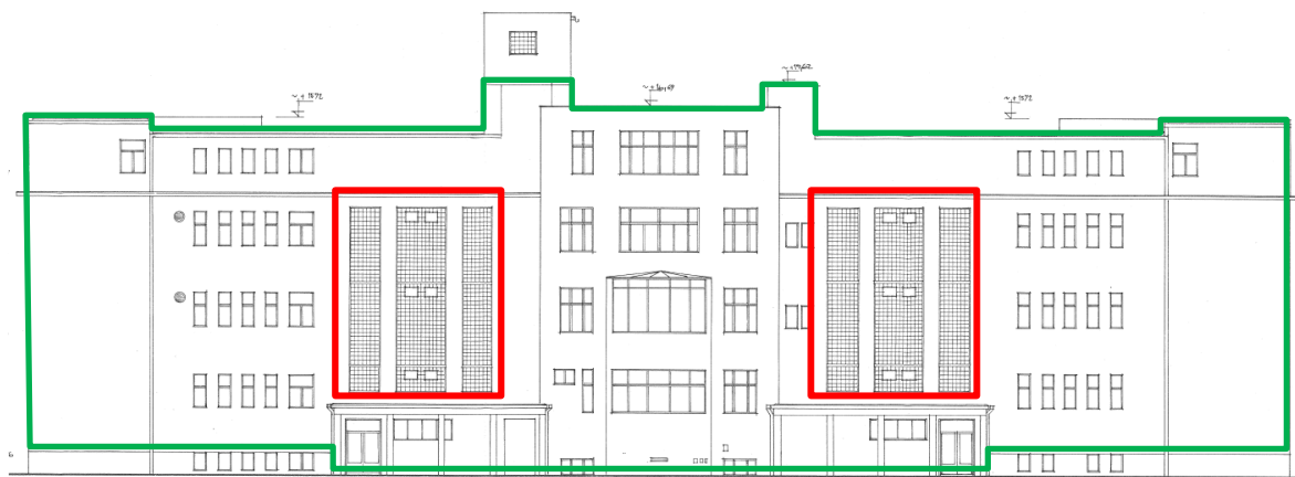
Obr. 38: Severní fasáda – Pavilon C – vyznačení měněných výplní a plochy zateplované části Pozn.: Červeně jsou znázorněny měněné výplně, zeleně je znázorněna plocha pro dodatečné zateplení obvodového zdiva
